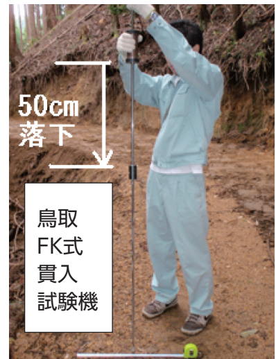
おもりを5回落下させて貫入量を測定
